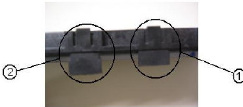
(1. prawidłowe mocowanie; 2 nieprawidłowe mocowanie)
