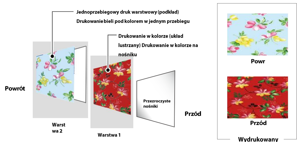
Przykład drukowania w kolorze + jednoprzebiegowe drukowanie warstwowe
