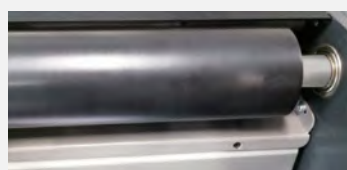
Dodatkowy wałek o zwiększonej średnicy
