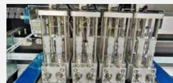
Podciśnieniowy system wyrównawczy atramentu
