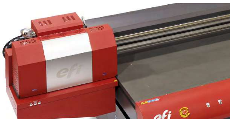
Głowice w technologii grayscale
