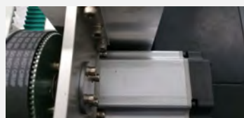
Napęd servo o mocy 750 W
