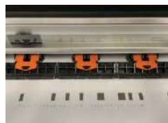
Media Tracker - automatyczne podawanie ilości materiału pozostającego na rolce
