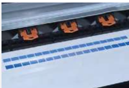
Automatyczna kalibracja grubości mediów
