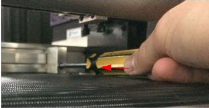
Rysunek 6-20: Poluzuj śruby na blokach prowadzących
