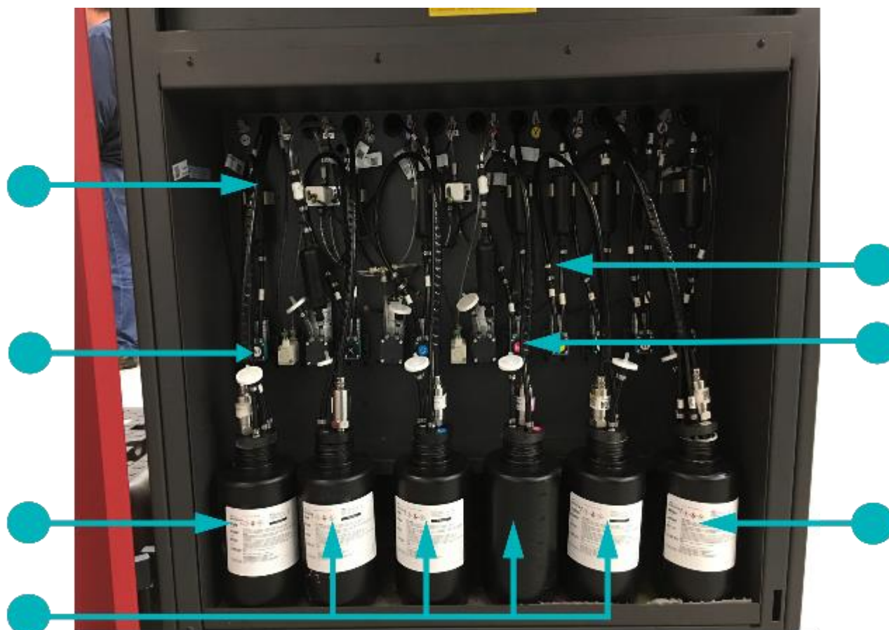
Rysunek 3-17: Dostarczanie tuszu i przedział pompy
