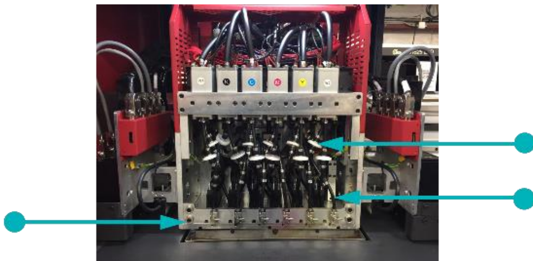
Rysunek 8-1: Typowa konfiguracja głowicy drukującej
