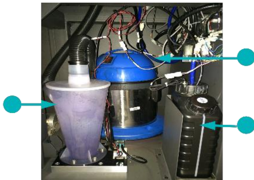
Rysunek 3-14: Komora na odpady (cyklonowy układ podciśnieniowy, kanister próżniowy i pojemnik na odpady atramentowe)
